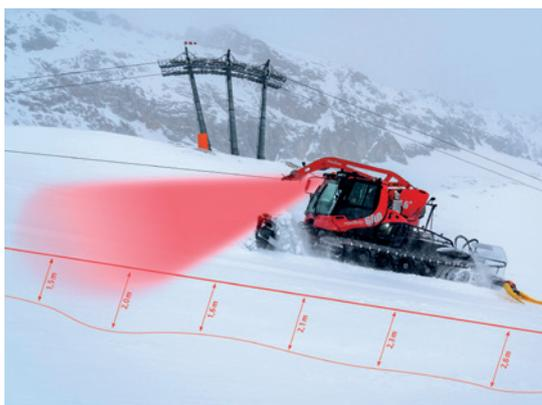
Le nouveau système permet une mesure du manteau neigeux sur un rayon de l'ordre de 30 mètres devant le véhicule : un pas de géant en matière de gestion de l'épaisseur de neige sur les domaines skiables !
